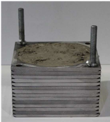
Mit Beton gefülltes Probengestell
