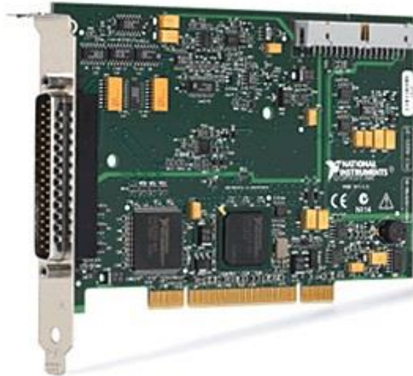
Abbildung 8: 37-Pin PCI-6221 Datenerfassungskarte (Quelle: [4])
