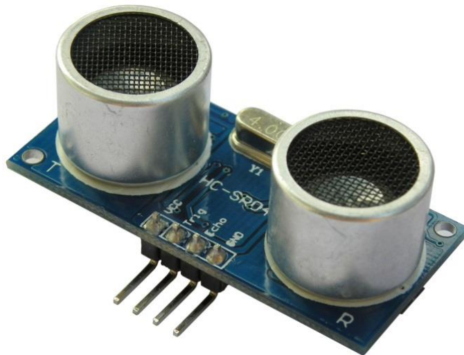
Abbildung 5: Ultraschallsensor HC-SR04 (Quelle: [3])
